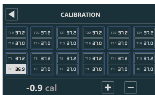
Kuva 13.19 T1-alueen lämpötilanäytön kalibrointi
